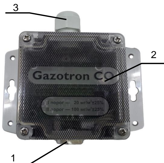
1 – датчик; 2 – светодиод; 3 – гермоввод Рисунок 2 – Сигнализатор двухблочного исполнения (блок питания не показан)
